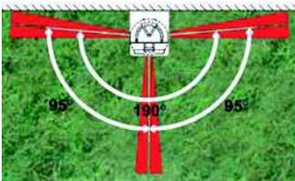
La rotule permet un alignement horizontal de 190°, ce qui permet une détection plus fine sans fausses alarmes.
