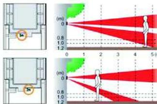
Changer la portée de détection est très simple : il suffit de tourner la lentille.
