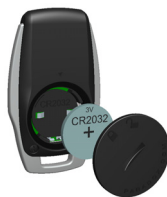
Figure 1 Remplacement de la batterie
