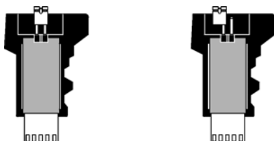
Figure 23 : Paramètres du cavalier PMC5 Cavalier en position On Cavalier en position Off
